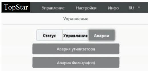
Во вкладке «Аварии» отображаются текущие аварии вентиляционной установки.
