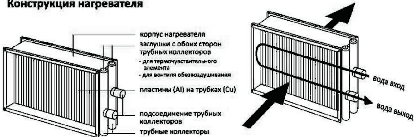
Рисунок 16. Конструкция водяного нагревателя
