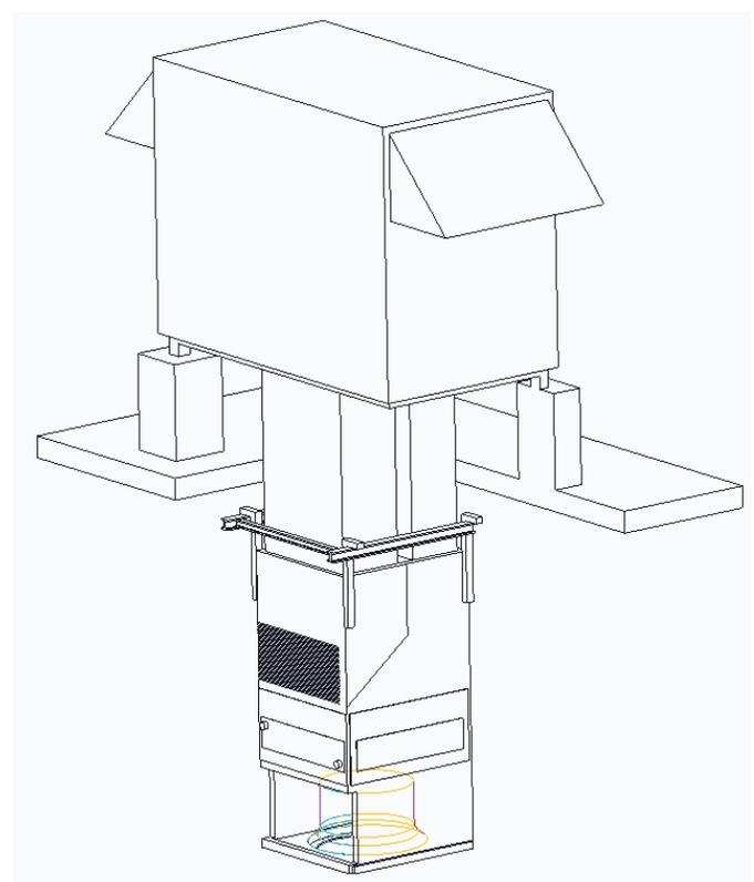
Рисунок 27. Крепление установки на опорные балки
