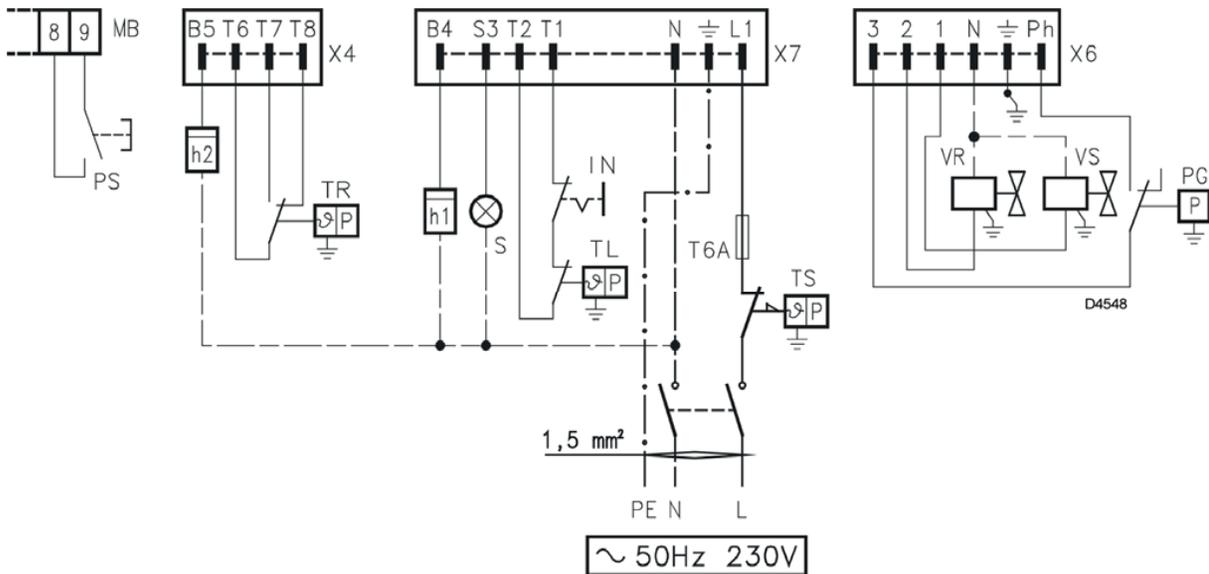
Рисунок 21. Схема электроподключения
